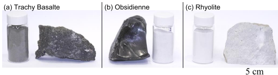
Fig. 7.4. Photographies de roches volcaniques avant et après broyage (a) trachy-basalte du Massif Central, (b) obsidienne de Californie, et (c) rhyolite du Massif Central. La composition chimique de l'obsidienne est très proche de celle de la rhyolite (cf. Figure 7.2).
