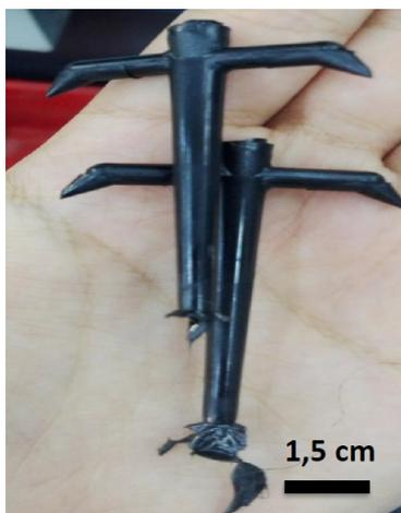
FIGURE 2.34 – Matière refroidie dans le canal d'injection, appelée carotte.
