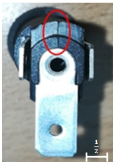
FIGURE 2.15 – Composite verres/PBT riveté endommagé, pièce d'étude de la thèse d'Oumeyma Hamlaoui [61].
