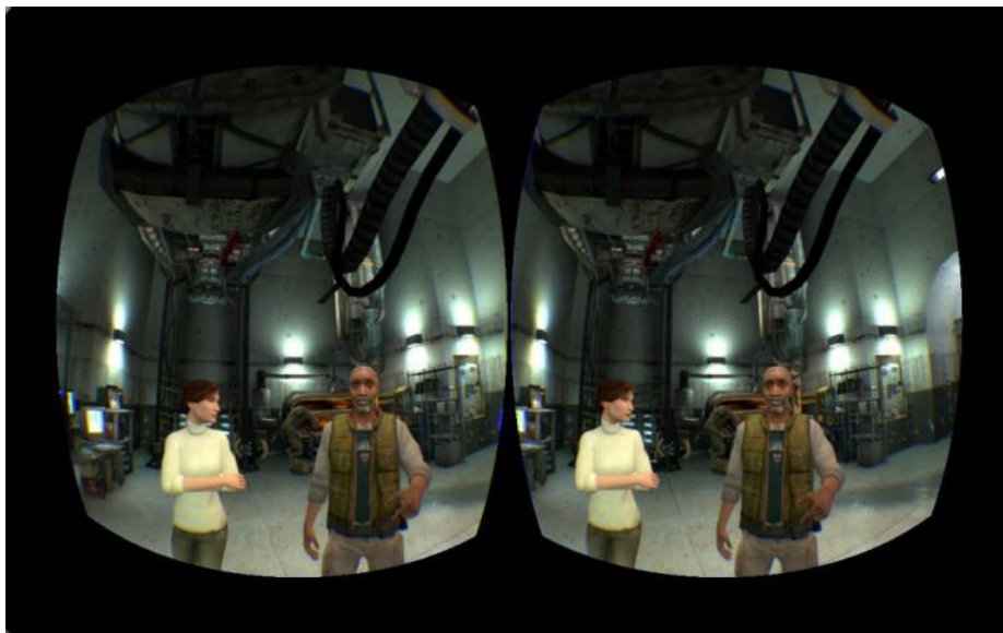
Figure 46 : application pour Oculus rift, on peut y voir l'utilisation de la déformation de Watson (Application VR 2016)
