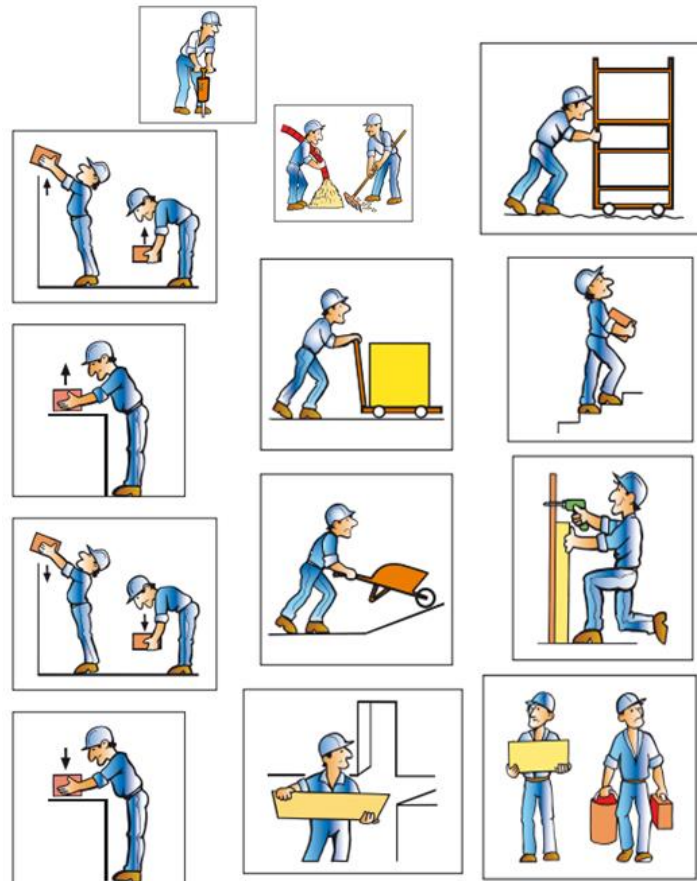
Figure 90 : les mouvements et charges provoquant des TMS dans le BTP, secteur dans lequel les TMS sont nombreux (Baranski et al. 2003)
