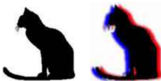
Figure 32: Aberration chromatique liée à une lentille, exemple : à gauche, l'image souhaitée, à droite l'image à travers la lentille (Dupontbloch n.d.)
