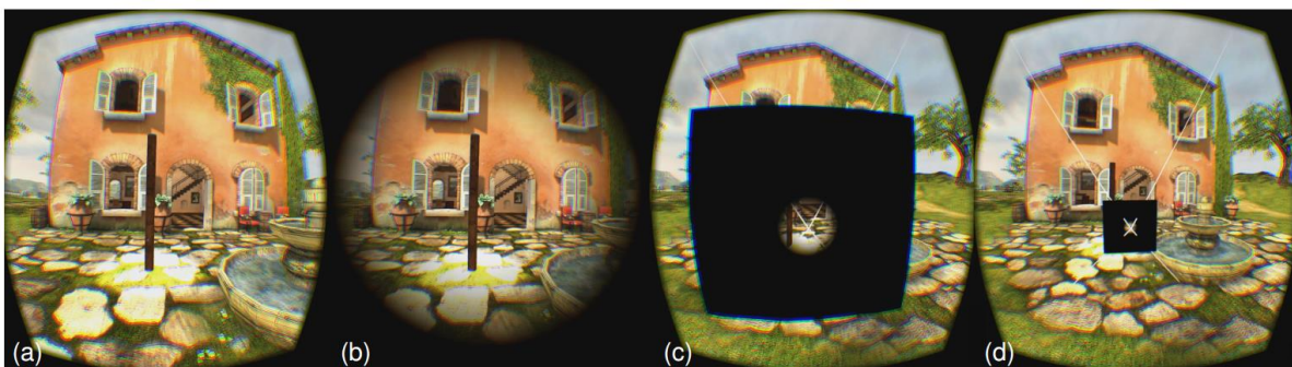
Figure 78 : modification des FOV pour réduire le cybermalaise en HMD (Fernandes and Feiner 2016)
