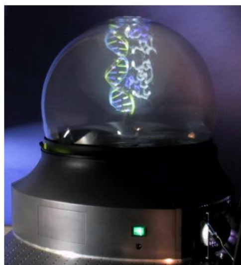
Figure 72 : dispositif de projection volumique rotatif de Favalora (Favalora et al. 2002).
