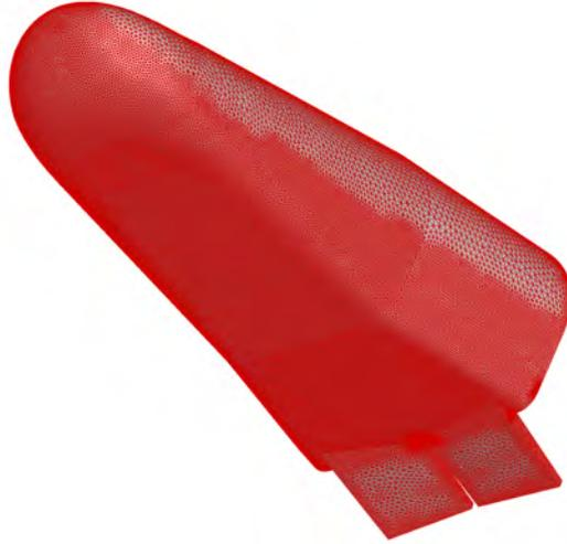
FIGURE 6.13 – Maillage surfacique de l'IXV composé de 82726 éléments.
