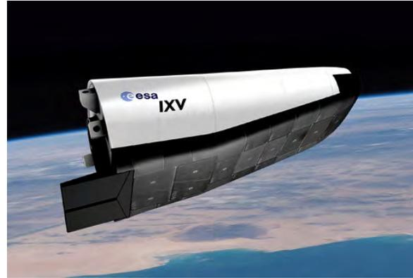
FIGURE 4 – Véhicule réutilisable IXV ayant effectué une rentrée atmosphérique en 2015 (crédit Dassault).
