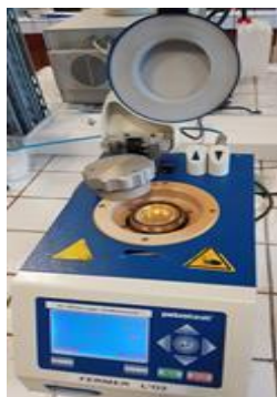
Figure I. 14 - a) Schéma représentant le dispositif PetroOXY 100 b) Représentation du temps d'induction ( t_{ind} ) avec une diminution de la pression totale de 10 % obtenue à l'aide du dispositif PetroOXY lors de l'autoxydation du n-décane à 413 K et une pression de 700 kPa d'oxygène initial 119
