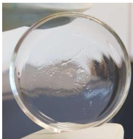
Figure V.2. 16 - Vue du gel formé lors de l'oxydation du carburant modèle ( T = 160 °C, P_{O_2} = 700 kPa, \Delta P/P_{max} = 10 %)
