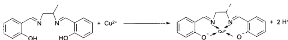
Figure I. 32 – Réaction de chélation entre la N,N'-disalicylidine-1,2-propane diamine et un ion métallique Cu (II) 153
