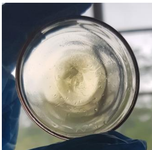
Figure IV.2. 15 - Vue du gel formé à l'issue de l'oxydation du MN ( T = 160\text{ }^{\circ}\text{C} , P_{O_2} = 700\text{ kPa} , \Delta P/P_{max} = 10\% )
