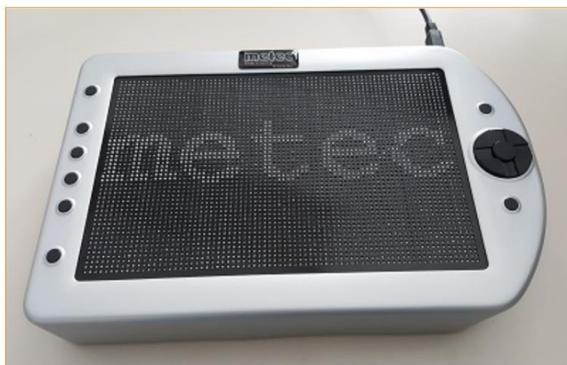
Figure 58 : Exemple de tablette à haute résolution (vendue par Hyperbraille : http://www.hyperbraille.de/ )
