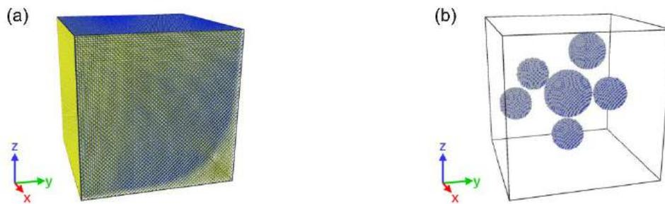
Figure 3-59 : Image de la boîte de simulation (a), position des nanoparticules de TiC dans la boîte de simulation (b), en jaune les atomes Si, en bleu les atomes C et en gris les atomes Ti.
