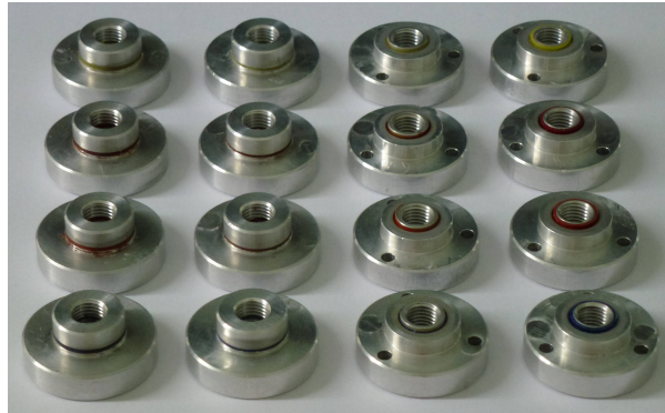
FIGURE 2.8 – Echantillons de compression (gauche) et de cisaillement (droite) pour le banc DMA 2012.
