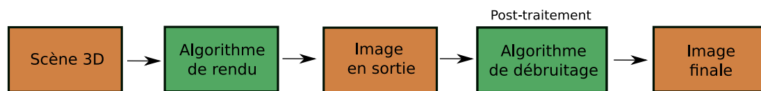
FIGURE 2.1 – Illustration du pipeline de rendu d'une image avec un post-traitement visant à la reconstruction de l'image par le biais d'algorithmes de filtrage.
