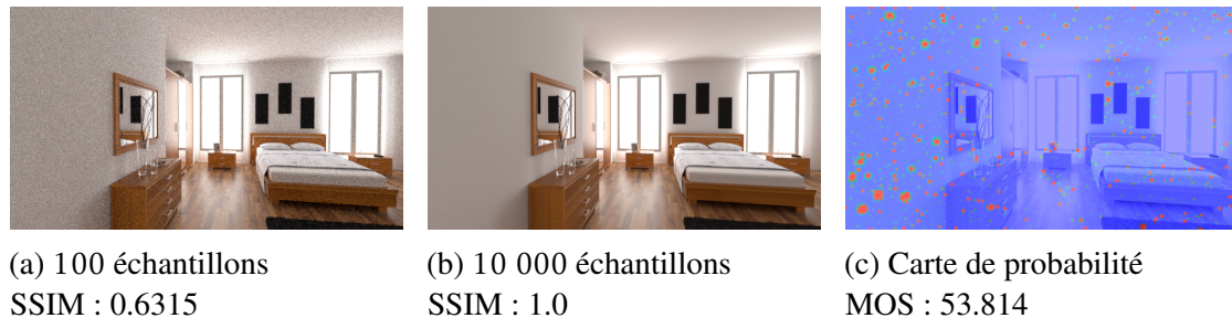
FIGURE 4.4 – Comparaisons de la SSIM et du HDR-VDP sur un point de vue de la scène Bedroom où l'image bruitée est calculée avec 100 échantillons et celle de référence de 10 000 échantillons par pixel. La carte de probabilité des différences et le score MOS du modèle HDR-VDP sont extraits, sachant que ce score est compris entre 0 et 100. Le score de 0 signifie une différence totale des deux images et un score de 100 correspond à deux images identiques.
