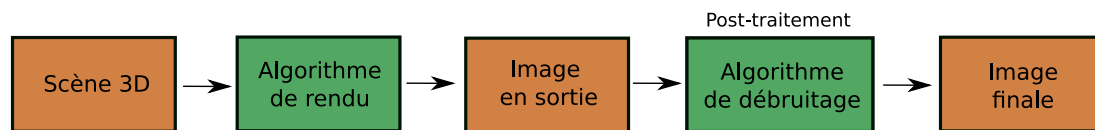
FIGURE 2.1 – Illustration du pipeline de rendu d'une image avec un post-traitement visant à la reconstruction de l'image par le biais d'algorithmes de filtrage.
