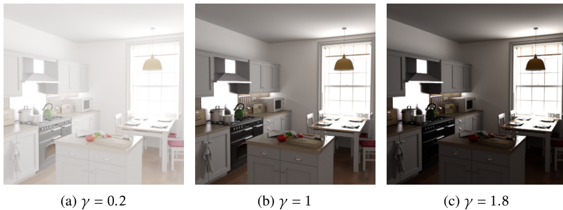
FIGURE 5.2 – Aperçu de différentes valeurs de correction \gamma appliquées à l'image originale ( \gamma = 1 ) de la scène Kitchen .
