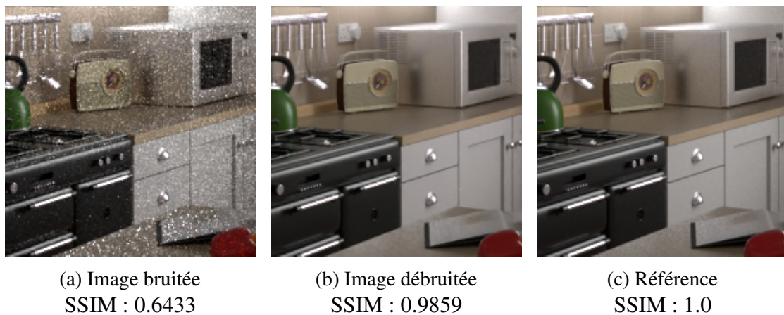
FIGURE 8.5 – Résultat du débruitage par le Denoising AutoEncoder sur un bloc de l'image Kitchen avec les scores SSIM correspondants.
