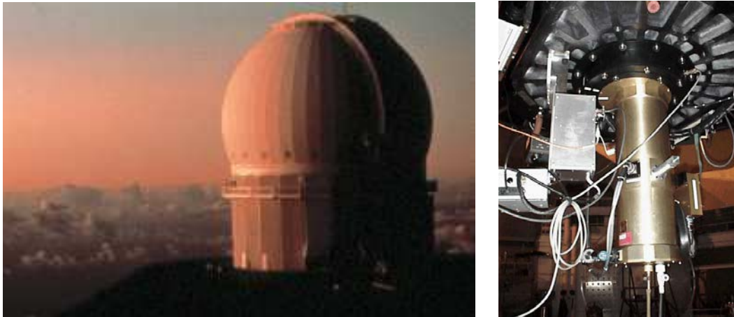
FIG. 4.3: Images du site du CFHT, au sommet du Mauna Kea, à Hawaii (gauche) et de PUEO/KIR (à droite), le système d'optique adaptative et la caméra infrarouge que nous avons utilisés.
