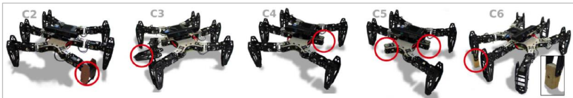
Figure 47: Ensemble des pannes testées ; certaines pattes du robot sont cassées (cas 2, 4 et 5), montée à l'envers (cas 3) ou remplacée par un autre dispositif (cas 6).
