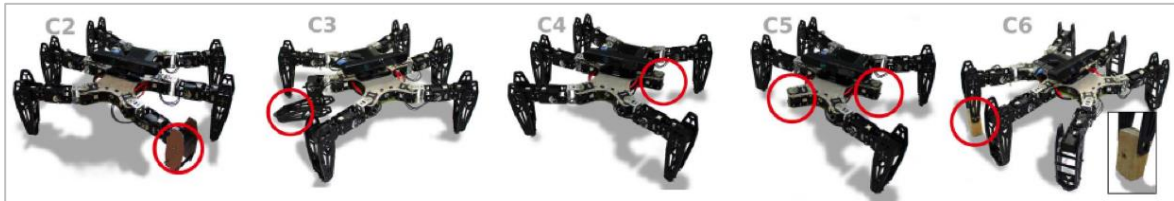
Figure 15 : Ensemble des pannes testées ; certaines pattes du robot sont cassées (cas 2, 4 et 5), montées à l'envers (cas 3) ou remplacées par un autre dispositif (cas 6).
