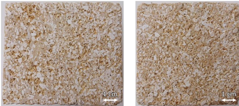
Figure 21 Pierre de Beaulieu, parallèle et perpendiculaire à la stratification
