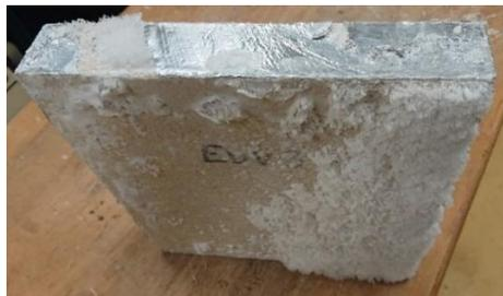
Figure 41 Salpêtre ( $\text{KNO}_3$ ) sur pierre d'Euville : anomalie lors d'un essai de perméabilité à la vapeur d'eau
