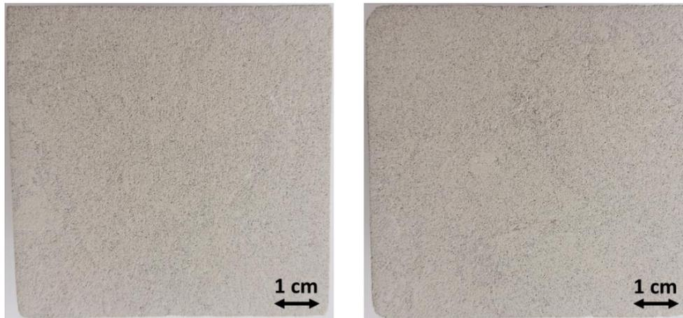
Figure 31 Pierre de Tuffeau, parallèle et perpendiculaire à la stratification
