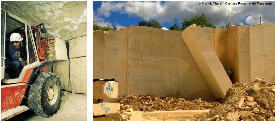
Figure 89 Sciage au fil, à la haveuse, carrière souterraine et abattage d'une quille en carrière (crédits photos : CTMNC, Franck Charel)
