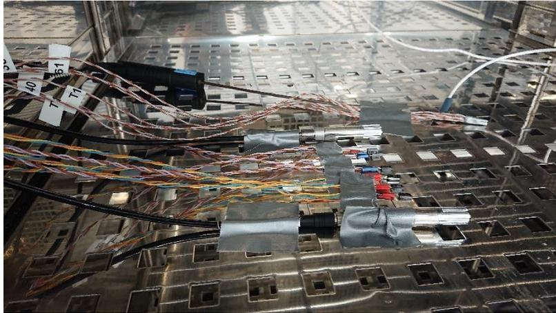
Figure 121 Étalonnage des capteurs dans l'enceinte climatique
