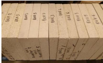
Figure 65 Panel des éprouvettes utilisées pour la détermination de la conductivité et de la capacité thermique
