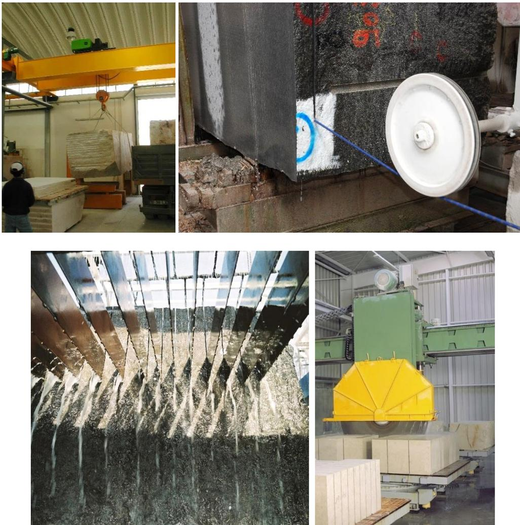
Figure 91 Maintenance puis opérations de découpe : fil, châssis multi-lame et disque (crédits photos : CTMNC)
