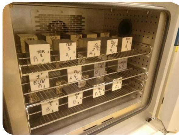
Figure 45 Photographie de l'essai de MBV (enceinte climatique et éprouvettes)
