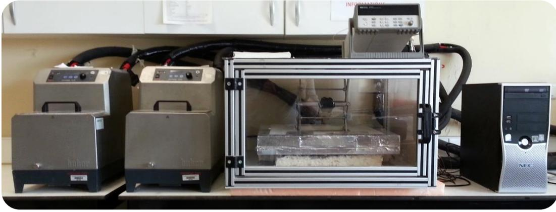
Figure 63 Photographie du banc expérimental (conductivité et capacité thermique)
