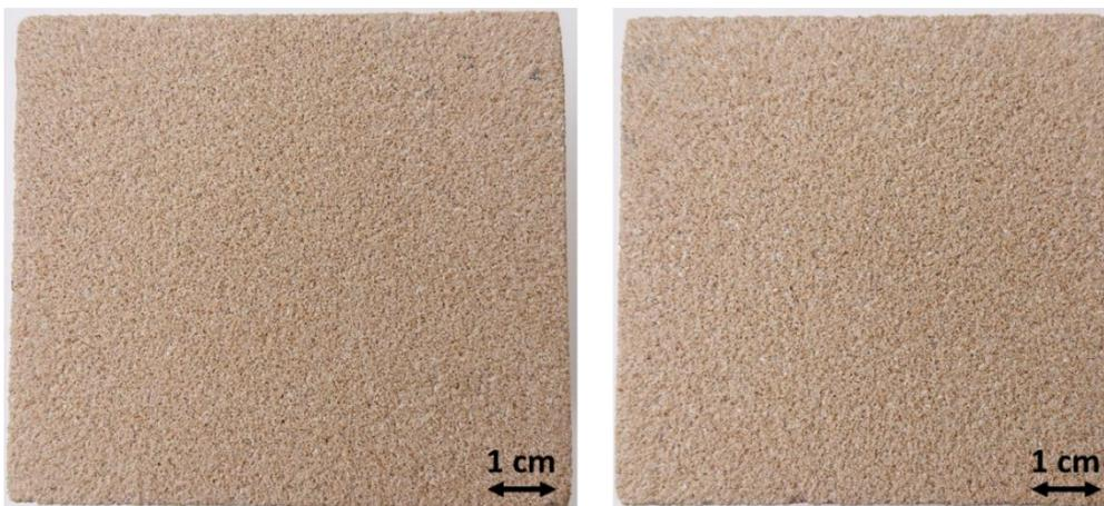
Figure 28 Pierre de Saint-Vaast Fine, parallèle et perpendiculaire à la stratification
