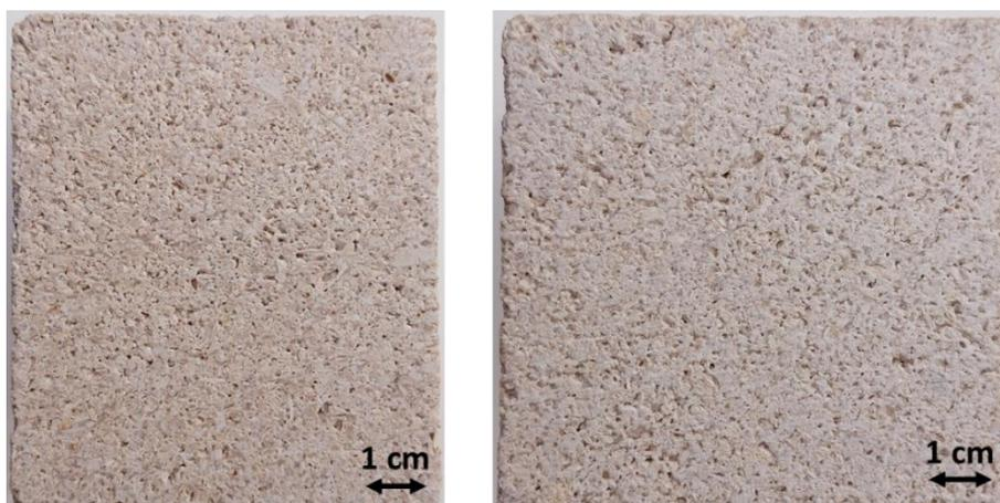
Figure 24 Pierre d'Euville, parallèle et perpendiculaire à la stratification
