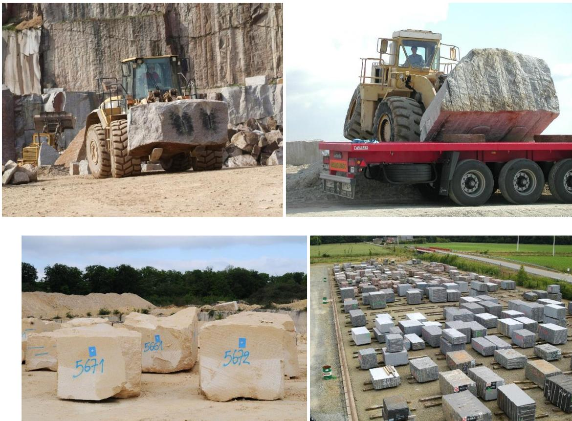
Figure 90 Transport et stockage des blocs (crédits photos : CTMNC)
