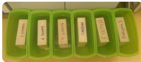
Figure 34 Éprouvettes lors de l'essai d'absorption d'eau à pression atmosphérique
