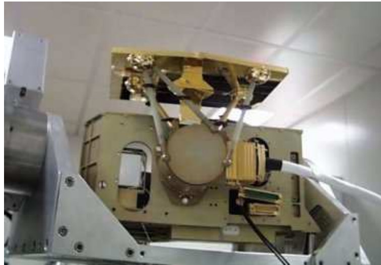
Figura 1.16: Vista del FPA montato sulla parte posteriore del banco ottico. Si noti in alto il radiatore per il raffreddamento passivo del CCD.
