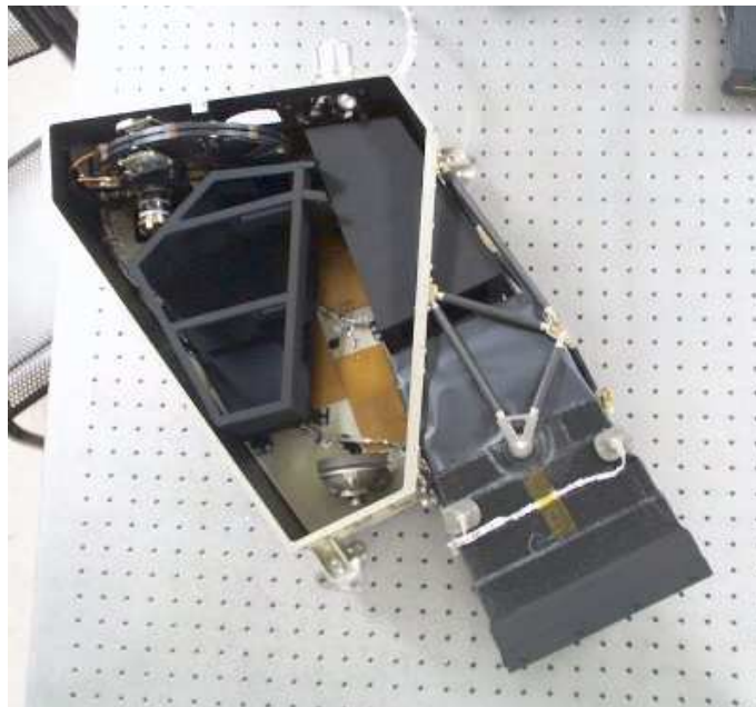
Figura 2.32: Vista dall'alto del modello FM della WAC. È ben evidente la struttura del baffle interno, in 2 box, cui si attacca, termicamente disaccoppiata, quella del baffle esterno.
