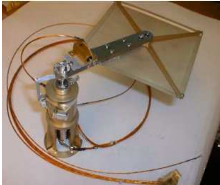
Figura 1.15: Foto del meccanismo del front cover della WAC. Come nel caso dello shutter, il medesimo meccanismo del front cover viene impiegato anche nella NAC, ove cambia solamente la forma da quadrata a rotonda.
