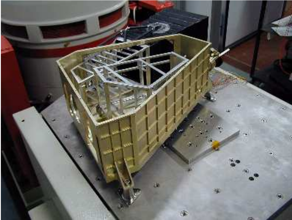
Figura 2.29: Immagine della struttura della WAC: è evidente la struttura del banco ottico con i rinforzi strutturali per il posizionamento dei vani interni, non ancora integrati; in alto si vede il baffle esterno, già integrato
