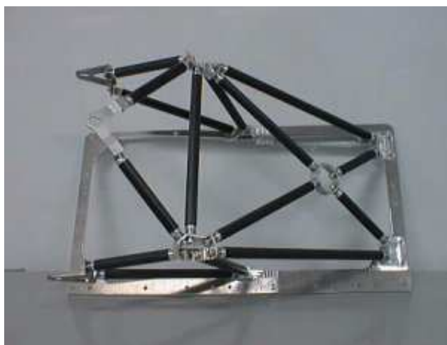
Figura 2.31: Struttura in fibra di carbonio usata per connettere il baffle esterno al telescopio.
