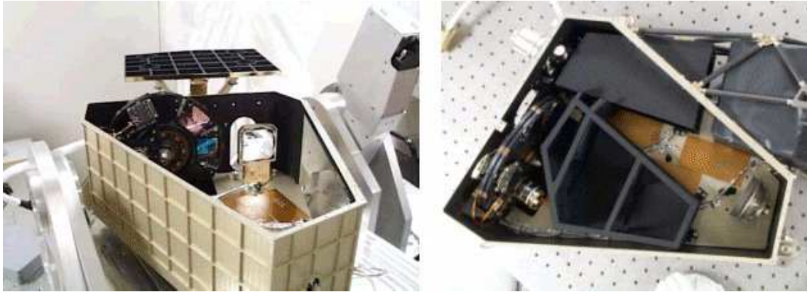
Figura 1.13: La WAC vista dall'alto in 2 differenti fasi di montaggio. A sinistra si vede il banco ottico con M1, le ruote portafiltri ed il radiatore del CCD, il tutto prima del montaggio del sistema di baffling. Nella foto di destra è stato inserito il sistema di baffling, già verniciato; si vede M2, in basso a destra, mentre M1 (in alto a sinistra) è coperto dalla prima sezione di baffle interno; il Focal Plane Assembly, contenente il CCD, viene montato sul muro esterno a sinistra. Sul pavimento della camera sono visibili anche i riscaldatori per il controllo termico dello strumento.
