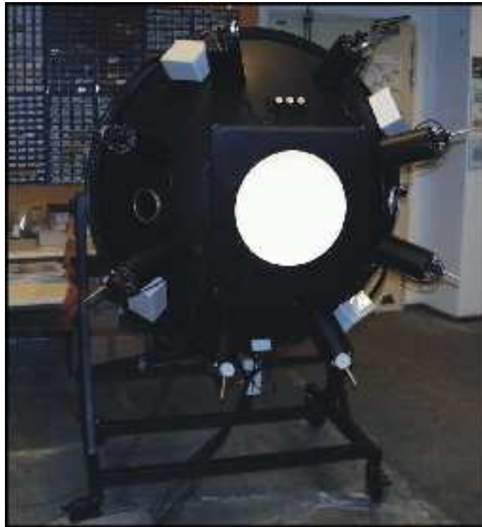
Figura 3.2: Foto della sfera integratrice utilizzata per le calibrazioni radiometriche: la sfera è rivestita da materiale completamente diffondente (parzialmente visibile dall'apertura della sfera) e dotata di lampade alogene calibrate e non.
