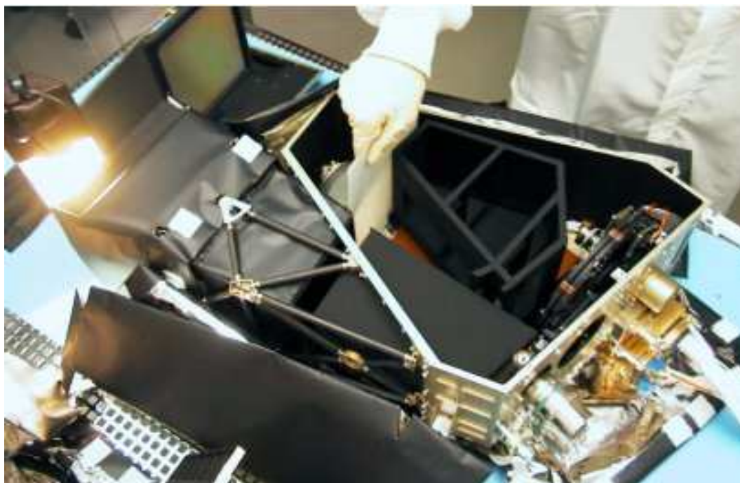
Figura 3.4: Analisi qualitative condotte sul QM della WAC per identificare le cause di stray light .
