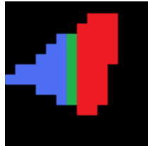
Figure 3-31 : Ouverture photométrique de 15x15 pixels. Elle a 61 pixels utiles et un SSB de 377.
