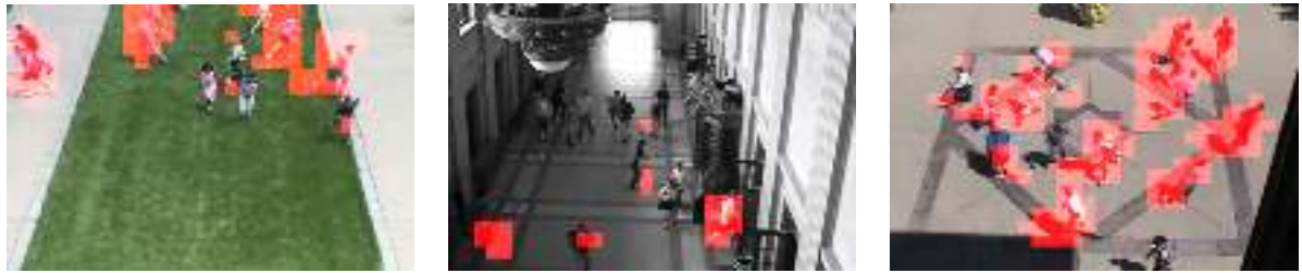
FIGURE 4.4 – Exemples de détections d’anomalies sur des images extraites de la base de données UMN.
