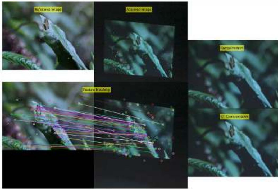
FIGURE 2.3 – Exemple de compensation géométrique de vidéos projetées [SG16]. La méthode fait coopérer d’une part un appariement de points d’intérêt couleur pour compenser les fortes distorsions, d’autre part une approche de flot optique pour corriger les faibles déformations entre deux images successives. Elle opère l’appariement entre la vidéo de référence (en haut à gauche) et la vidéo observée. Dans ce travail, le système caméra-projecteur est mobile et le contenu de la vidéo est dynamique. À droite, on compare la compensation obtenue avec la compensation issue de la vérité terrain ( ground-truth GT).
