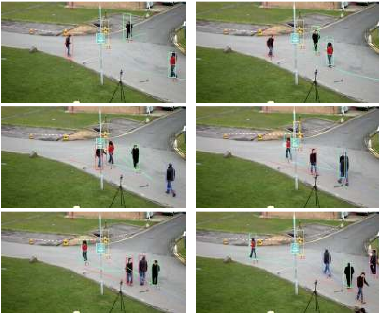
FIGURE 3.15 – Images issues de la séquence PETS2009-S2-L1-Time_12-34-View_001 qui montre des personnes qui se croisent et s’occulent. La minimisation d’énergie utilisant l’apparence permet de suivre les trajectoires et maintenir l’identité des objets.
