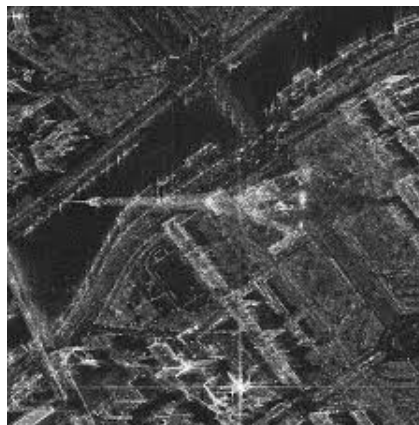
FIGURE 1.9 – Exemple de distorsion géométrique sur une image SAR de la tour Eiffel prise par le satellite TerraSAR-X.
