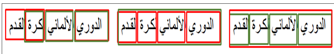
FIGURE 5.7: Cas de correspondance entre G_i (en vert) et D_i (en rouge) : de gauche à droite respectivement : (a) : one to one, (b) :one to many, ( c) : many to one
