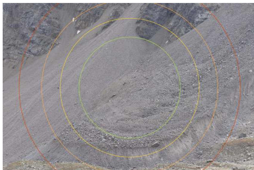
Figure 2.7 – Visualisation de la distorsion calculée par ajustement de faisceau, d'un appareil photo reflex Nikon D800 avec une focale de 85 mm. Le premier cercle indique une distorsion de 0.1 pixel, le second 0.25 pixel, le troisième 0.5 pixel et le dernier 1 pixel.
