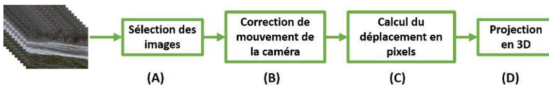
Figure 2.1 – Chaîne de traitement classique pour le calcul de déplacements à l'aide d'un appareil fixe et d'un modèle numérique de terrain.
