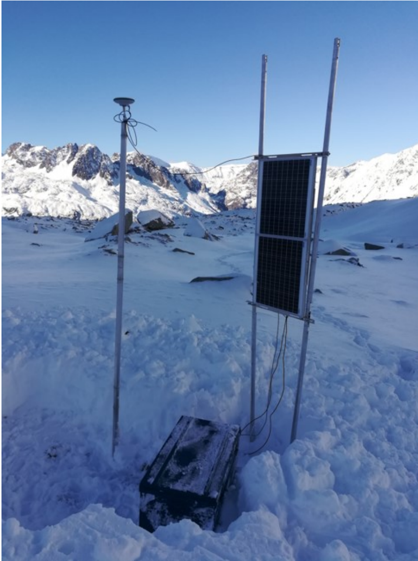
Figure 3.1 – Un des GPS à la surface du glacier d’Argentière mi-novembre 2019.
