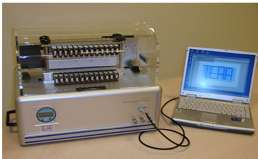
Figure 20 : Préleveur automatique SASS (Smart Automatic Samplig System) de TERA environnement
