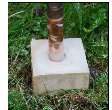
Fig.2.88 T12 : forage tubulaire d'un bloc de calcaire avec une pâte abrasive
