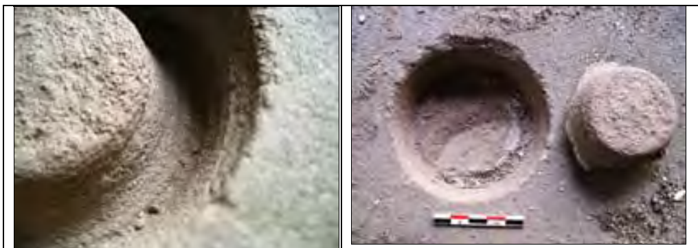
Fig. 2.85 et 2.86 Carotte et trou de forage obtenus après 1heure de travail
