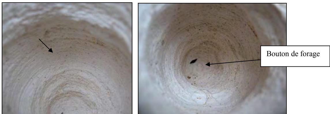
Fig. 2.173 et 2.174 Stries de forage obtenues. Elles sont régulières dans la zone d'élargissement
