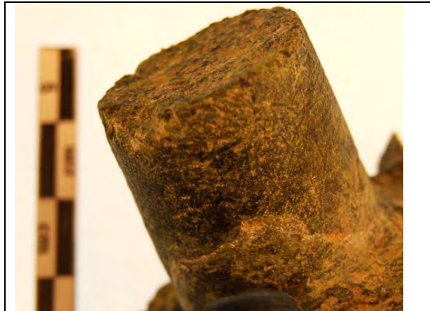
Fig. 2.119 T 26 : sablage de la partie proximale de la carotte n° 13
