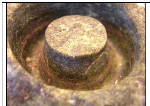
Fig.2.67 T8 : carotte de forage obtenue
