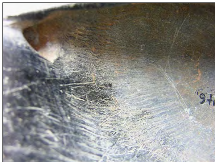
Fig. 3.89 Traces de raclage à l'entrée de la cavité
