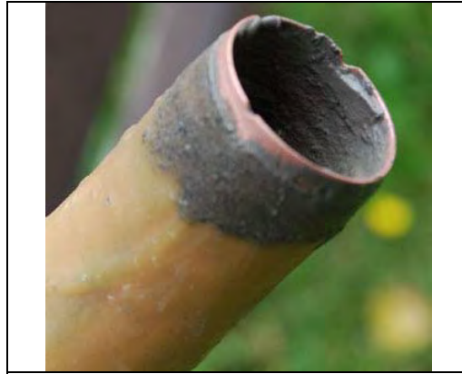
Fig.2.133 T 33 : les particules abrasives se sont incrustées dans la cire. Cette dernière s'use assez lentement et perdure assez bien à l'intérieur du tube
