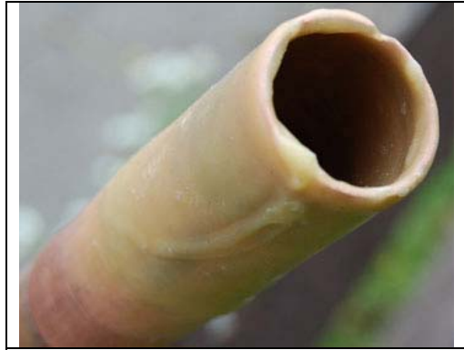
Fig. 2.130 T 33 : tube enduit de cire d'abeille
