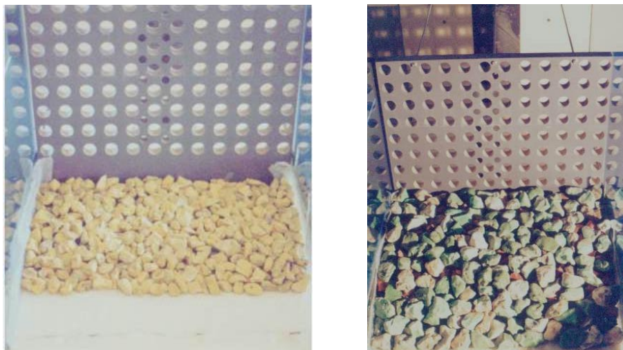
Figure 3-12 : Deux étapes de construction de la berme moyenne.
