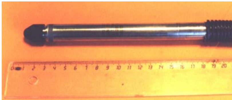
Figure 2-19 : Photographie d'un capteur Druck PTX 1830.
