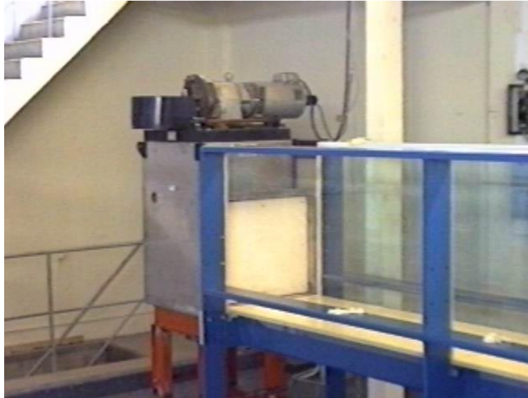
Figure 3-3 : Vue du générateur de houle monochromatique.
