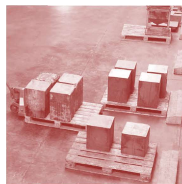
Fig. 243. Lingots de silicium en amont de la découpe des wafers
