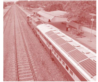
Fig. 235. Train avec panneaux photovoltaïques
