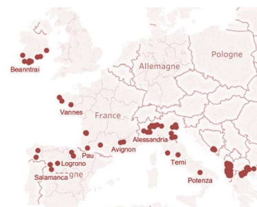
Fig. 450. Carte de temps de retour carbone pour le passage d'un double en triple vitrage et dans le cas d'une production de chaleur par gaz naturel. Ci-dessous, extrait de la carte avec les emplacements où les temps de retour carbone seraient supérieurs à 5 ans.
