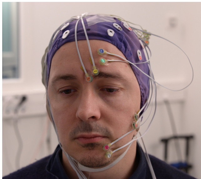
FIGURE 6.2 – Positionnement des électrodes du dispositif d'enregistrement EMG sur le visage d'un participant.
