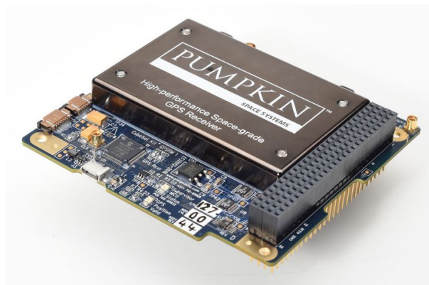
FIGURE 4.21 – Récepteur GPSRM de la société Pumpkin, retenu pour équiper IGOSat
