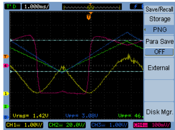
(b) Visualisation du signal d'erreur PDH (courbe rose) en fonction de la tension de l'actuateur piezo-électrique du laser (en vert).
