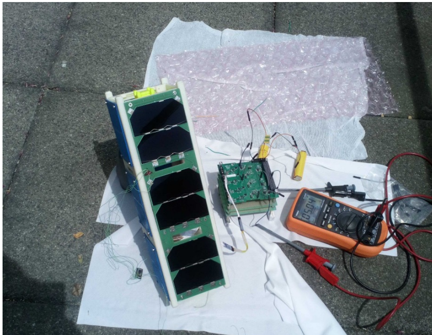
FIGURE 4.24 – Système d'alimentation électrique d'IGOSat (panneaux photovoltaïques, carte de régulation et batteries) pendant un test fonctionnel sur un prototype.
