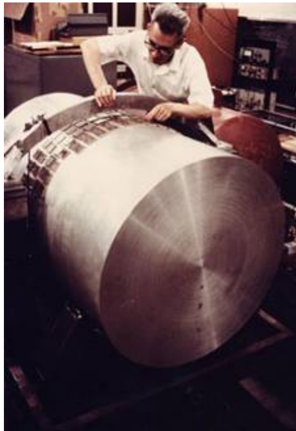
FIGURE 1.4 – J. Weber travaillant sur une des premières barres résonantes pour la détection des ondes gravitationnelles (vers 1969). Crédit : AIP Emilio Segrè Visual Archives.
