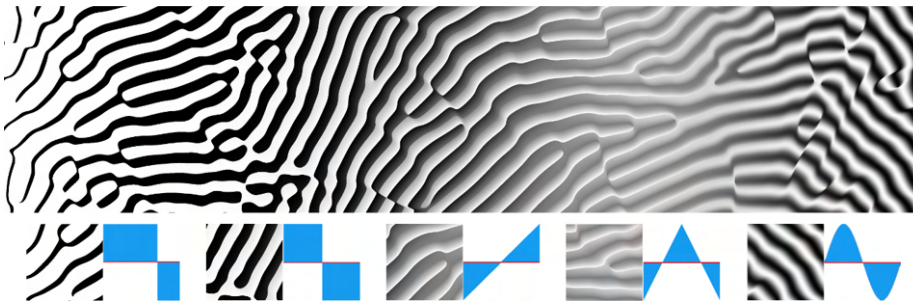
FIGURE 2.19 – Phasor noise présenté par Tricard et al. [TEZ + 19]. Une fonction de transfert appelée le « profil » est définie pour modifier l'apparence de la réalisation d'un bruit procédural.
