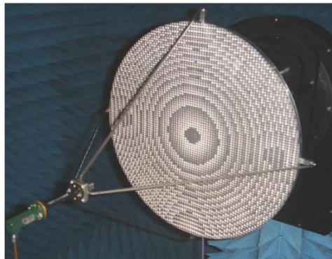
Figure 58 : Exemple d'une antenne à réseau réflecteur passif circulaire fonctionnant à 75 GHz [119].
