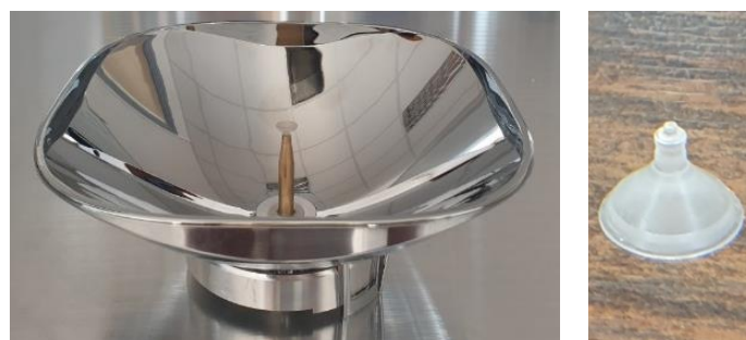
Figure 52 : Prototype de l'antenne parabolique SFA en bande D ; (a) vue de l'antenne complète ; (b) support diélectrique.
