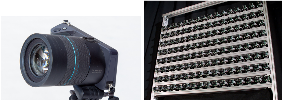
FIGURE 2 – A gauche, la caméra plénoptique Lytro Illum (source : Wikipedia ), à droite la matrice de caméras Stanford.
