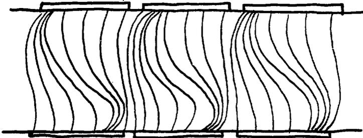
Figure V.5 distribution de courant avec segmentation fine.
