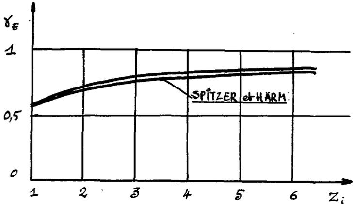
L'accord avec Spitzer et HARM est bon ( 8 % ). On note que la réduction de conductivité obtenue est légèrement plus faible.
