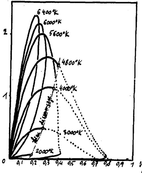
La limitation du rendement qui découle de ce mécanisme d'instabilité de régime est sévère : rendement inférieur à 20% pour  $T_g = 2000^\circ K$  dans nos conditions de calcul. Il est à noter qu'on peut relever le rendement maximum en accroissant le champ B, mais assez peu.
