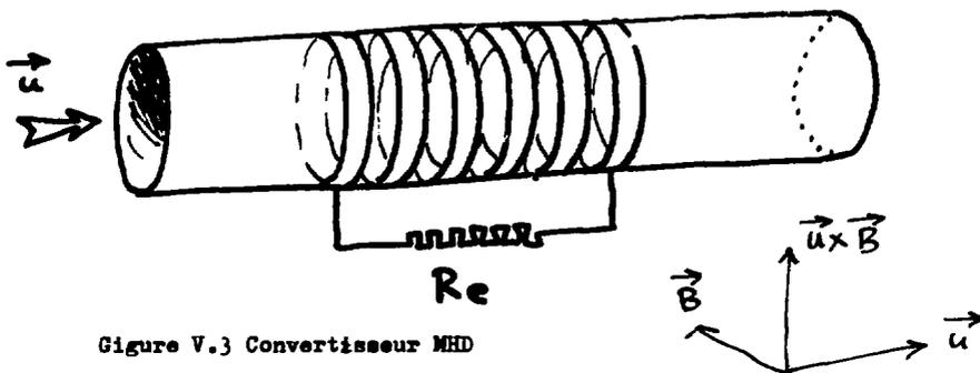
Figure V.3 Convertisseur MHD en montage de Hall.
