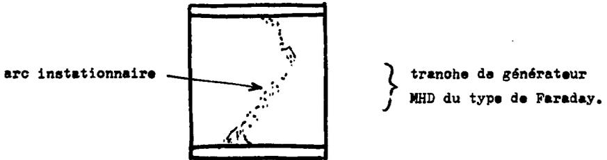
Si l'on pouvait créer entre les deux électrodes une colonne de gaz ionisé permettait l'initiation de l'arc, l'amorçage serait ainsi assuré. Ce qui suggère aussitôt l'emploi d'une décharge LASER :
