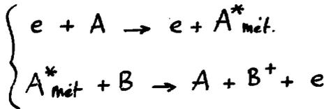
Le fluide caloporteur est alors constitué de deux substances A et B. L'atome A possède un niveau métastable (exemple Hélium) associé à une forte section efficace. La seconde collision entre un métastable A et un atome B provoque l'ionisation de B ( par exemple Argon ). Le rendement de ce transfert énergétique est bon si l'énergie métastable est supérieure et assez voisine de l'énergie d'ionisation de l'atome B.
