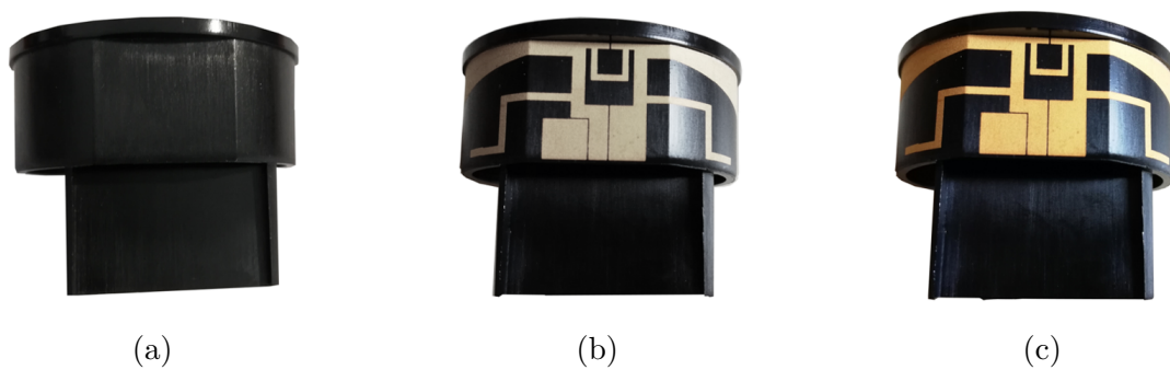
FIGURE III.9 – Étapes de réalisation LDS de l'antenne dipôle dual-band : (a) injection ; (b) activation laser ; (c) métallisation
