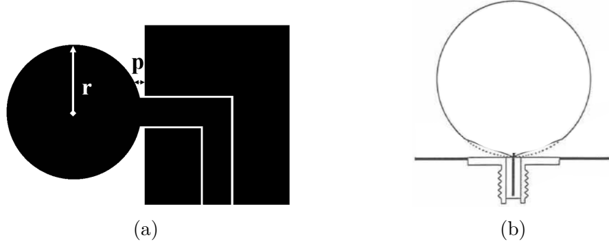
FIGURE III.18 – Antennes ULB monopoles circulaires : (a) version à angle droit proposée; (b) design initial [159]
