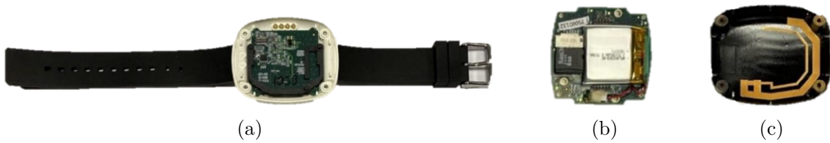
FIGURE I.5 – Utilisation de DIM pour un bracelet d'e-santé : (a) bracelet ; (b) batterie ; (c) antenne plastronique
