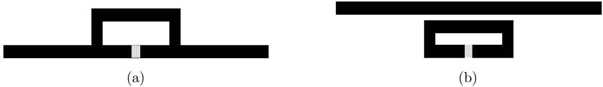
FIGURE II.14 – Variantes de l'adaptation en T (alimentation en pointillés) : (a) T inversé [116]; (b) boucle couplée [114]
