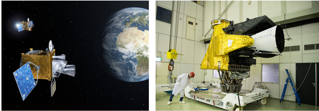
Figure 41 : A gauche : Vue d'artiste des deux futurs satellites géostationnaires européens du programme Météosat Troisième Generation. A droite : Photographie de l'instrument Flexible Combined Imager actuellement en construction. (Source : https://www.eumetsat.int ).
