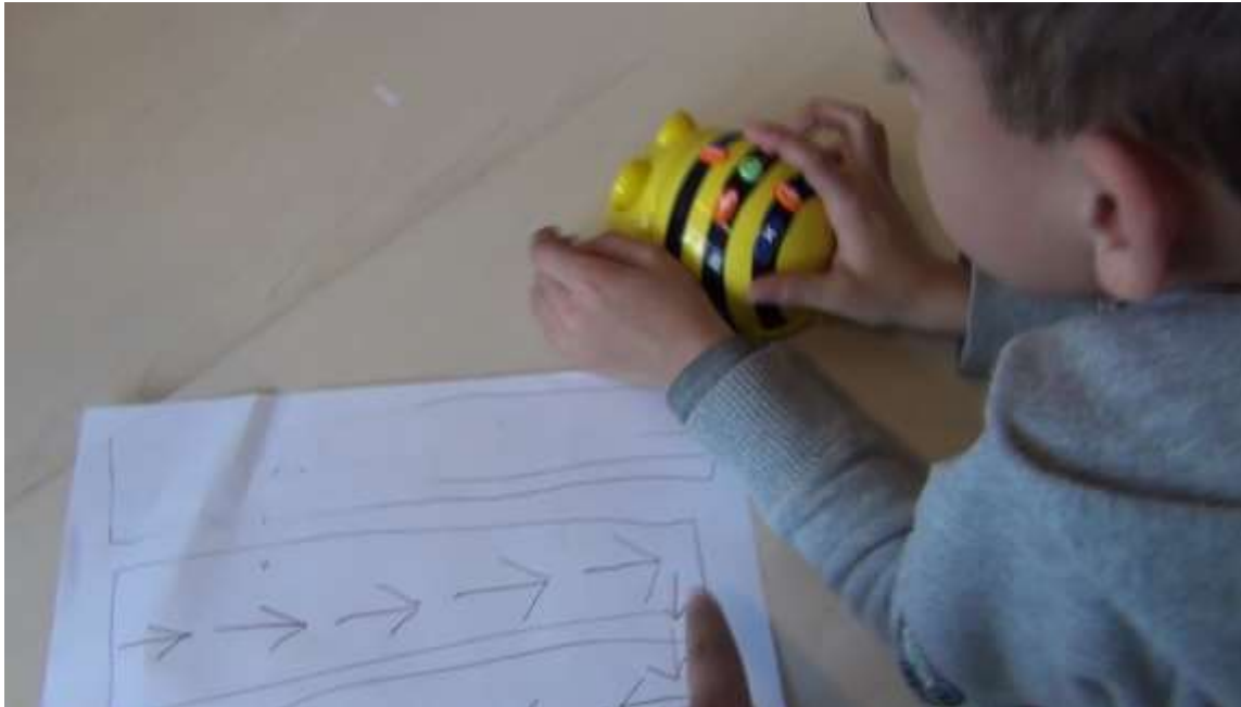
Figure 31. Implémentation du programme sur le pavé de commande de contrôle du robot
