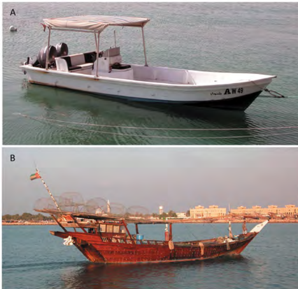
Figure 3.5. A. Bateau tarad en fibre de verre (environmentalatlas.ae); B. Boutre de pêche lansh , muni de plusieurs nasses sur le château arrière (ibid)
