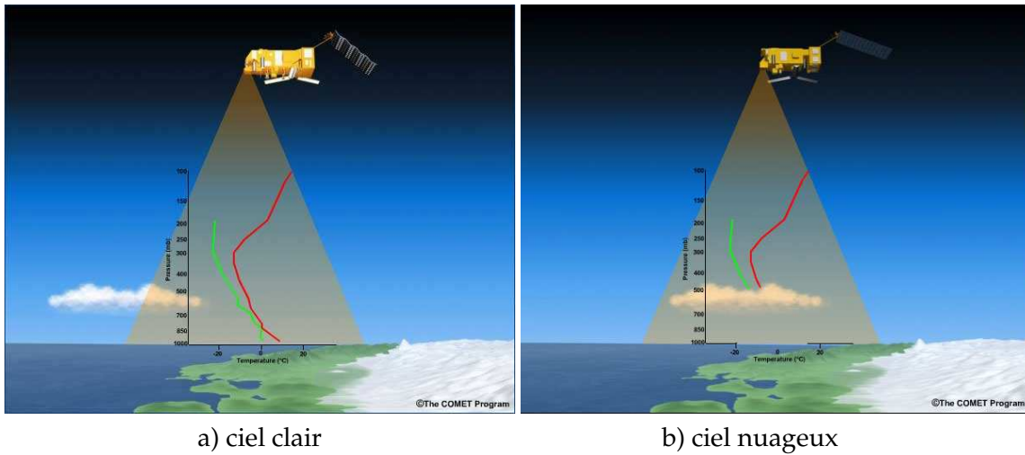
FIG. 2.2 – Principe du sondage de l'atmosphère en cas de ciel clair ou de ciel nuageux.
