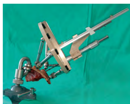
(b) Robot RoboJig directement attaché à l'os temporal, comme le Microtable.
