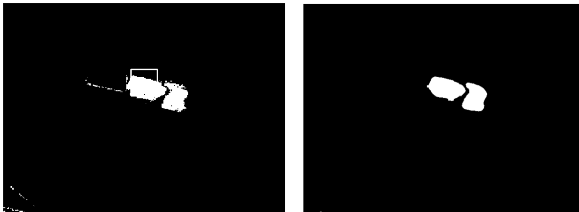
FIGURE 5.49 – Comparaison du mask sans (à gauche) et avec le filtre médian (à droite).
