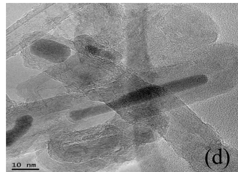
Figure II.27 : (a) Analyse ATG des membranes vierge (noir) et des membranes contenant des NTC synthétisés par CCVD. CNT1 (Catalyseur Fe, durée synthèse 3 h), CNT3 (Catalyseur Fe, durée synthèse 16 h), CNT 7 (Catalyseur Fe+Ca, durée synthèse 3 h). (b) Photo d'une membrane neuve et après synthèse. (c) Microtomographie X d'une membrane modifiée. (d) Analyse TEM des NTC synthétisés sur la membrane.
