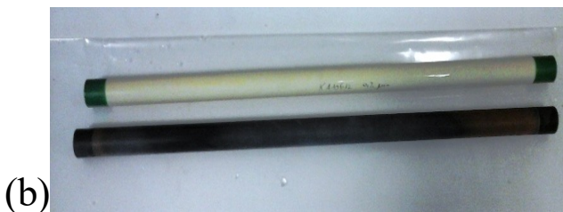
Figure II.27 : (a) Analyse ATG des membranes vierge (noir) et des membranes contenant des NTC synthétisés par CCVD. CNT1 (Catalyseur Fe, durée synthèse 3 h), CNT3 (Catalyseur Fe, durée synthèse 16 h), CNT 7 (Catalyseur Fe+Ca, durée synthèse 3 h). (b) Photo d'une membrane neuve et après synthèse. (c) Microtomographie X d'une membrane modifiée. (d) Analyse TEM des NTC synthétisés sur la membrane.
