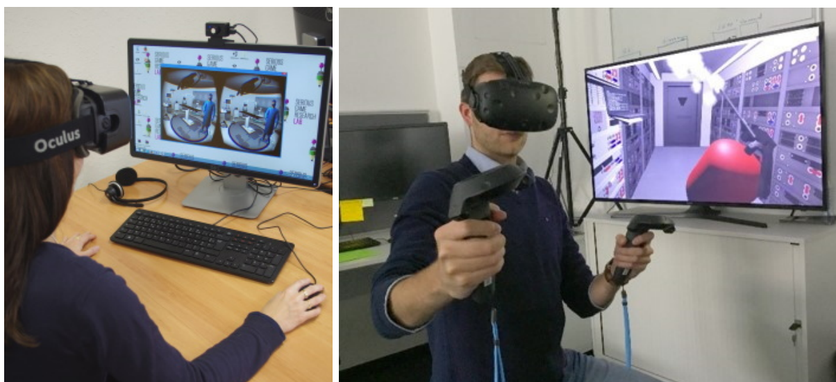
(a) Le clavier et la souris sont mal adaptés à la VR immersive. (b) Les contrôleurs 6 DDL offrent une bonne ergonomie dans les interactions immersives à la 1 ère personne.
